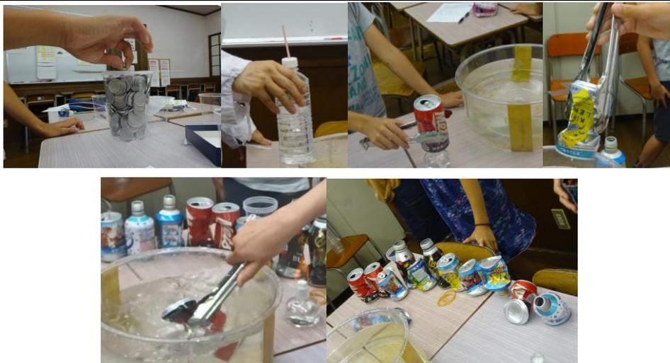
まずは空気の実験をしました。1円玉をたくさん入れたコップにふたをのせて上をひっぱると、コップが持ち上がりました。ふたが「大気圧」によって押さえつけられているためです。次に、水の深さによって「水圧」が変化することを確認する実験をしました。最後に、「大気圧」を利用して空き缶をつぶす実験をしました。途中からはコツをつかんで、何度も成功させた人もいました。
