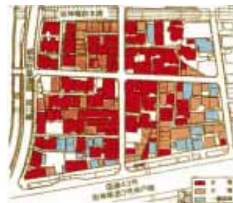
若宮地区の密集状況と震災被災状況 (赤全壊、桃半壊、青一部損壊)
